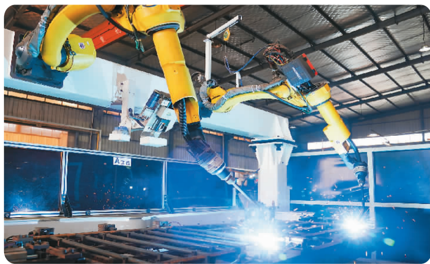
▲近年来，江西省新余市围绕5G应用、工业互联网等新兴领域，布局数字产业和数字经济，建设一批“智能工厂”“数字化车间”，推动产业转型升级。图为新余一家企业的焊装生产车间，自动机械臂在进行自动焊接作业。（人民图片）
