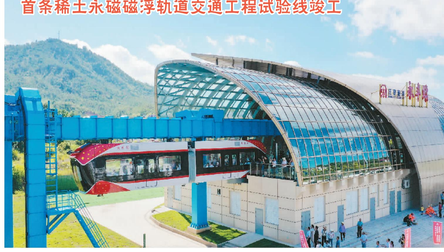
8月9日，国内首条稀土永磁磁浮轨道交通工程试验线——“红轨”在江西兴国县正式竣工。正线全长约800米，均为钢构高架线，最高设计运行速度为80公里每小时。图为“红轨”试验线列车驶出车站。
