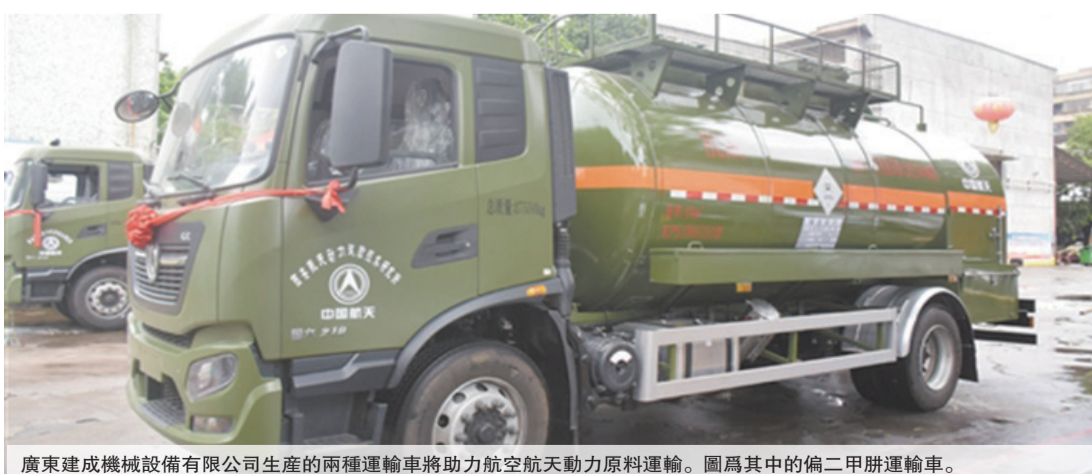
廣東建成機械設備有限公司生產的兩種運輸車將助力航空航天動力原料運輸。圖為其中的備二甲肼運輸車。
