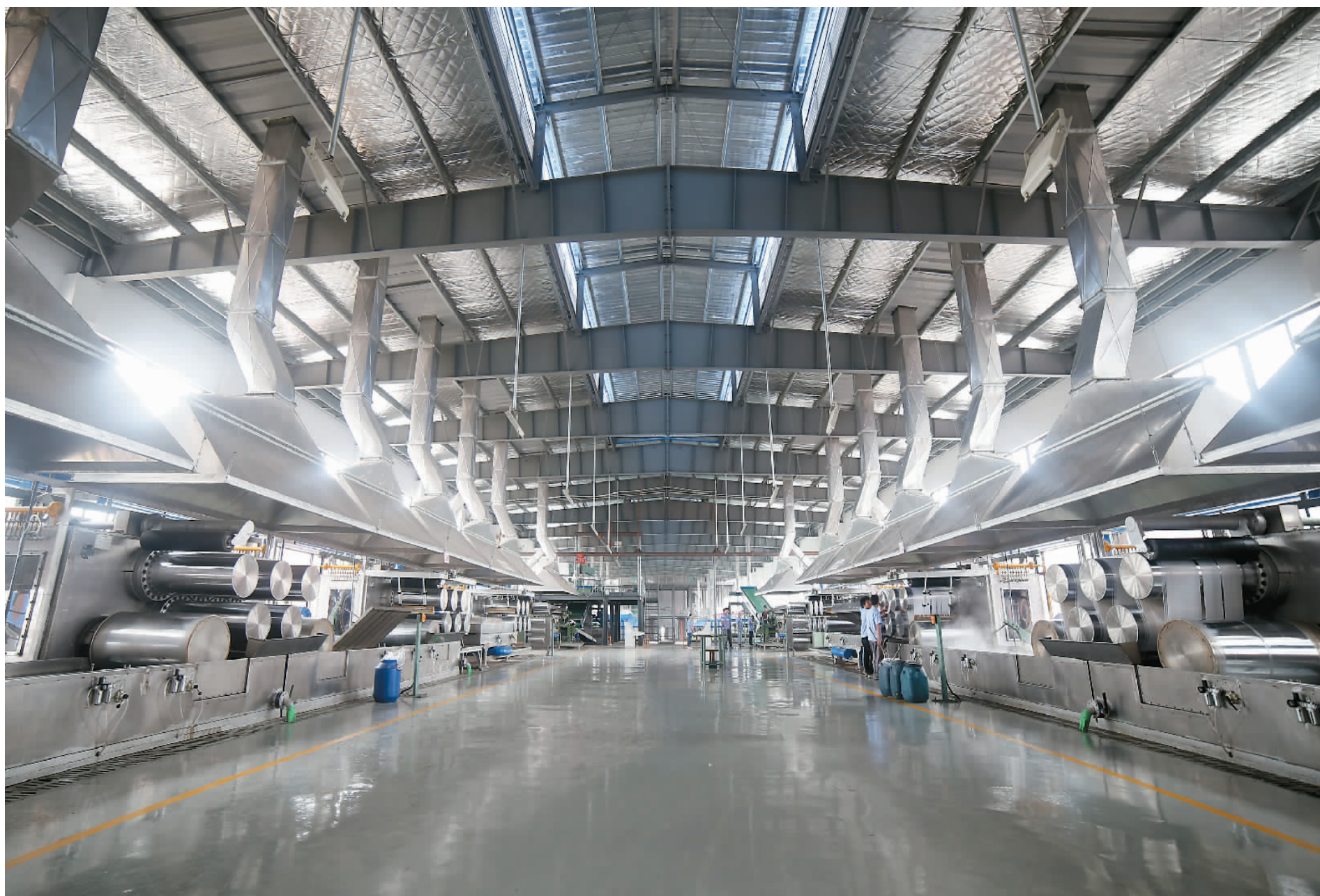
图为浙江省宁波大发化纤有限公司用来制作再生涤纶短纤维的拉伸工艺生产车间。
