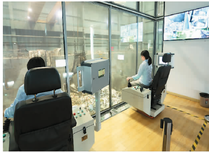
图为6月7日，在四川省眉山市仁寿县垃圾焚烧发电厂的垃圾吊控制室，工作人员正在操作垃圾焚烧工作。 潘帅摄（人民视觉）
