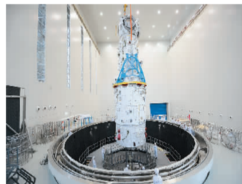
在中国航天科技集团五院天津基地内，天和核心舱在进行热试验前吊装（资料照片）。 新华社发（航天科技集团五院供图）
