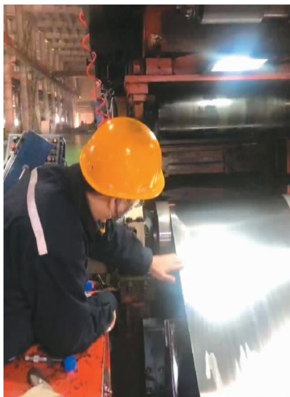
天材科技技术人员在观察轧制中的“手撕钢”表面质量。 受访企业供图
