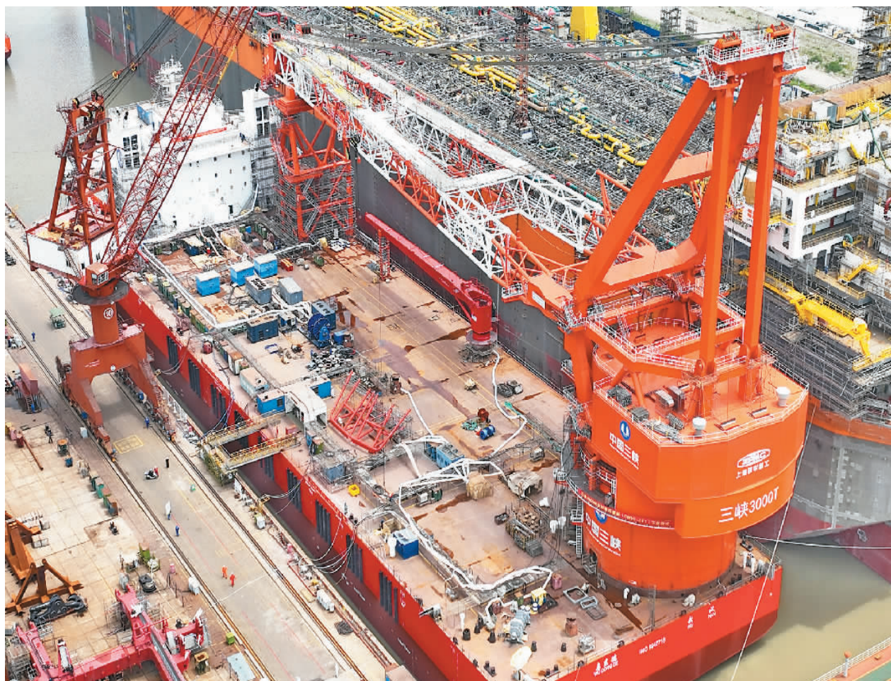
5月25日,在位于江苏省南通市海门区的招商工业海门基地,三峡集团3000吨全回转起重船顺利下水。该船是一艘集深远海风电基础运输和起重施工为一体的专业化风电施工船。该船建成后,主要用于10兆瓦及以上机组的桩基施工,可装载3600千焦等级打桩设备进行施工作业。 许丛军摄(人民视觉)
