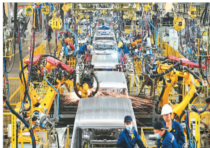
5月12日，在江西省赣州经开区，在山东凯马汽车制造有限公司赣州分公司冲焊车间，全自动机器人正在新能源汽车生产线上焊接作业。
