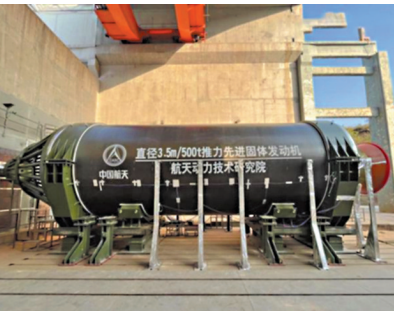
◆改變近地小行星軌道的關鍵之一是必須有大推力的運載火箭。圖為去年底中國航天試車成功的全球最大推力火箭發射機。受訪者供圖
