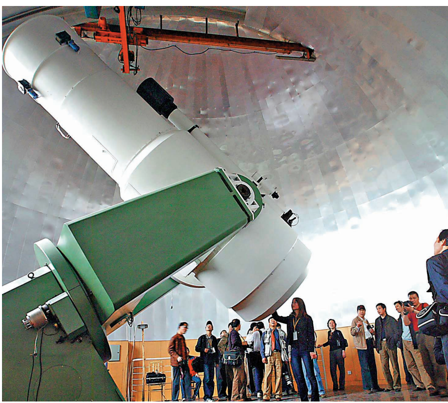
◆位於江蘇省淮安市盱眙縣觀測站的紫金山天文台1米近地天體望遠鏡，為觀測發現對地球構成潛在危險的近地天體而興建，可在短時間內拍攝到大面積的星區照片，取得大量的星空動態信息。資料圖片
