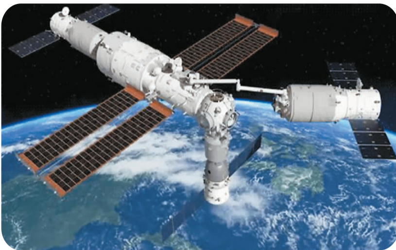
中国空间站机械臂对天舟二号货运飞船进行在轨转位示意图。
