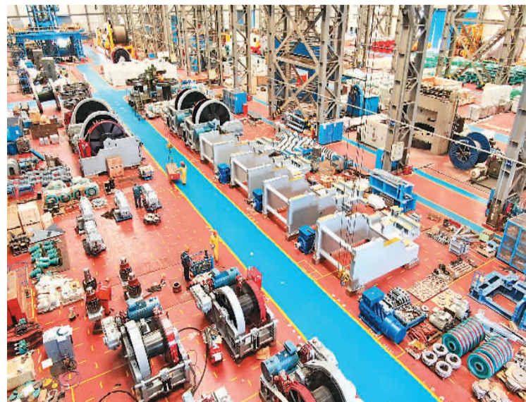
1月8日，工人在江苏南通振华重工南通传动大型海工车间内生产三峡风电施工船重型绞车和升降系统。许丛军摄（人民视觉）
