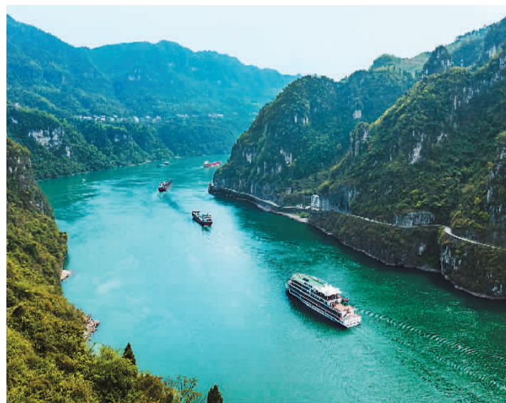
3月29日，由中国自主研发的新能源纯电动游轮“长江三峡1”号，在湖北省宜昌市秭归新港首航，这对加快内河航运绿色低碳发展具有积极示范意义。“长江三峡1”号纯电动游轮长100米，总宽16.3米，型深4米，乘客定额1300人，配备7500千瓦船用动力电池。图为“长江三峡1”号游轮行驶在宜昌市夷陵区水域。
