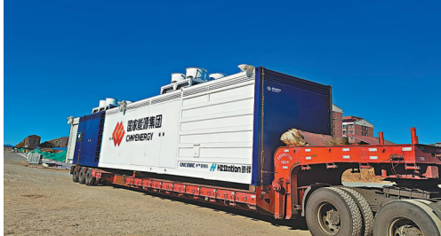
◆ 中集安瑞科為北京冬奧提供的70兆帕集裝箱全集成加氫站設備。
