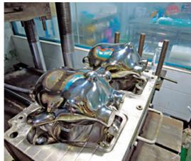
◆冰墩墩膠殼的生產廠商李寅貴手上捧着公司生產的冰墩墩外殼和冰墩墩樣板。右圖為生產線上的冰墩墩模具。
