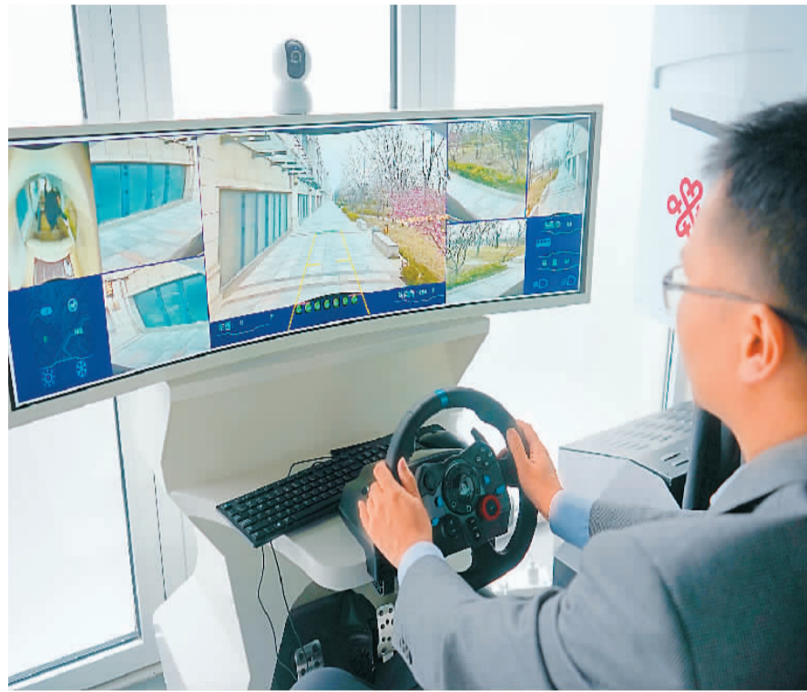
在雄安数字交通实验室,技术人员对无人驾驶汽车进行远程操控。
