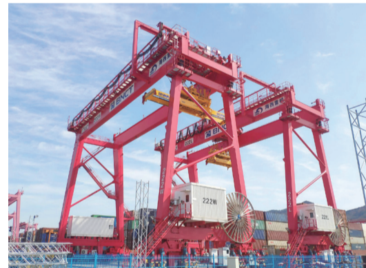
【青島海西重機為韓國釜山港制造的自動化軌道吊。海工裝備製造是西海岸新區的強項。王培珂攝】
