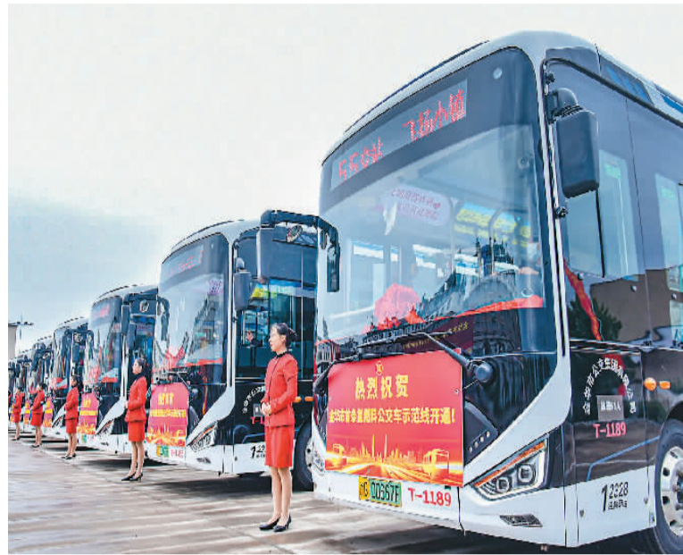
近日，浙江省金华市首条氢燃料公交车示范线——55路氢能源公交专线正式开通。该路公交车长8.5米，可载客60人。车搭载的核心驱动单元——60kW燃料电池发动机是名副其实的“金华制造”。（人民图片）
