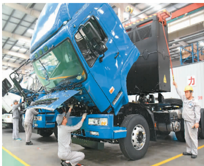
今年前10个月，安徽省马鞍山经开区汉马科技集团抢抓新能源汽车发展机遇，销售具有自主知识产权的搅拌车、牵引车和自卸车等新能源车达977辆。图为11月2日，该集团员工在安装纯电动搅拌车的可换电电池箱。 胡智慧摄（人民视觉）
