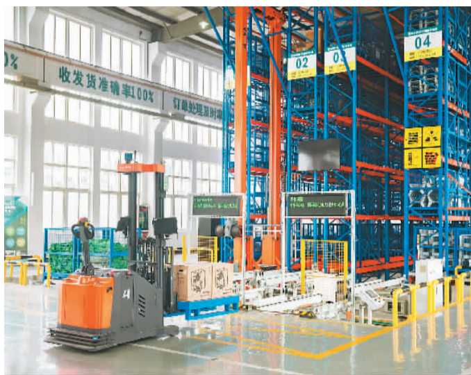
国网温州供电公司中心库积极参与自主创新,近期投入使用自动货架与搬运机器人设备,并开发智慧供应链平台予以管控。智能系统与设备启用以来,实现了电力物资出入库过程自动化流水作业,作业效率提升50%。 徐建超摄(人民视觉)
