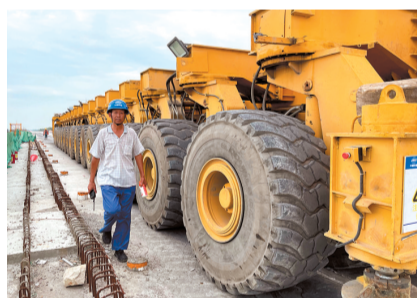
↑擁有68粒巨大輪胎運輸車,擔負起運送預製梁的任務。
