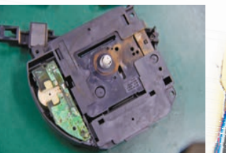
不少石英鐘表都因為電池滲漏，零件生鏽而損壞。
