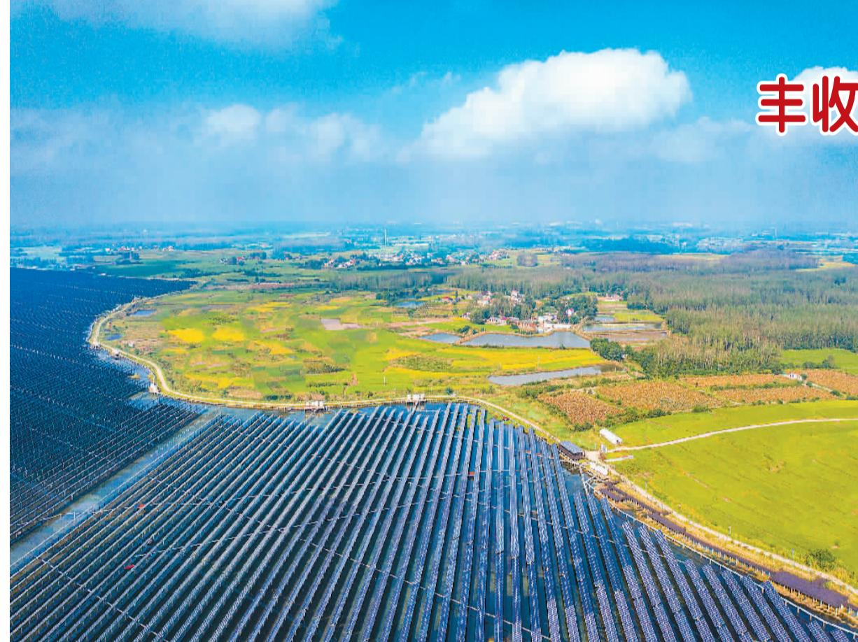
近年来，安徽省合肥市肥东县坚持生态优先、绿色发展，实施“生态+电力”助力碳中和，全面推进乡村振兴。据悉，该渔光互补光伏电站采用“水上光伏发电、水下渔业养殖”的一地两用模式，综合利用水域面积2400亩，带动地方实现经济、生态双丰收。
