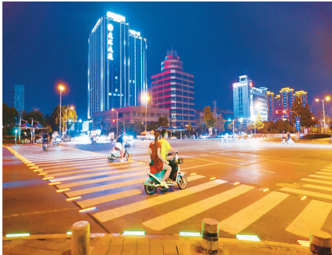
6月14日晚，一条可发光的智慧斑马线在安徽省六安市城区梅山南路与长安路交叉口闪亮上岗，为行人安全过马路保驾护航。该设备与交通信号灯同步联动使夜晚的人行道更加醒目，提示机动车减速慢行礼让，警示行人按交通信号灯安全通行。 田凯平摄（人民视觉）
