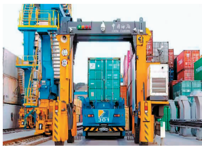
因为海关设置在自动化码头的先期机检设备，能实现对集装箱的顺势监管。
