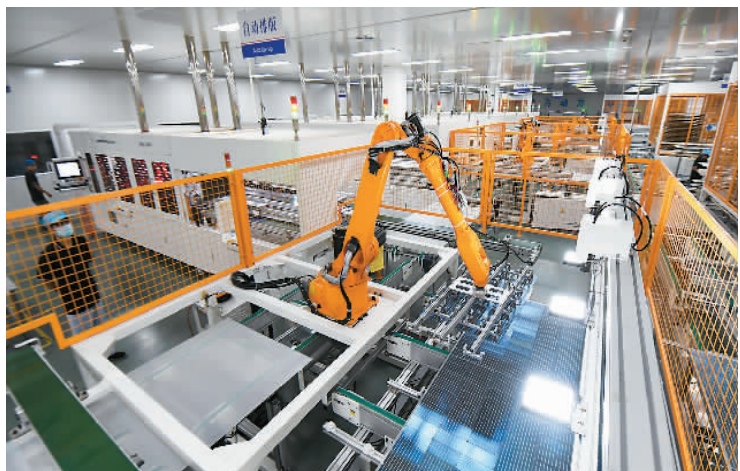
7月16日，江西省新余市一家科技公司太阳能组件车间，工业机器人在自动化生产线上精准操作，赶制高效光伏太阳能组件。 凌厚祥摄（人民视觉）
