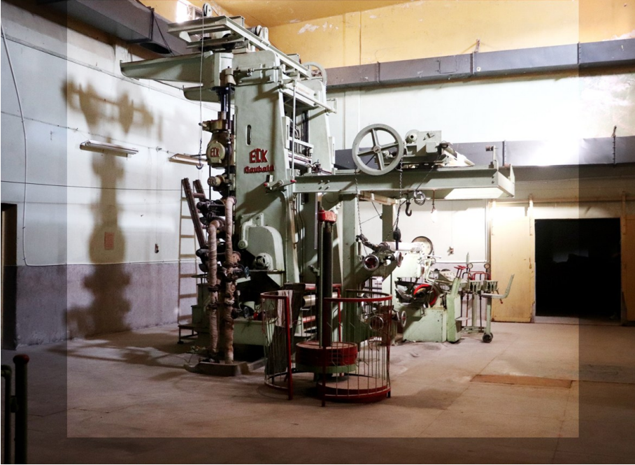
↑1956年從西德引進的領地紙七軋超級壓光機，同年在永安街老廠區投產，後搬遷來現主廠房
