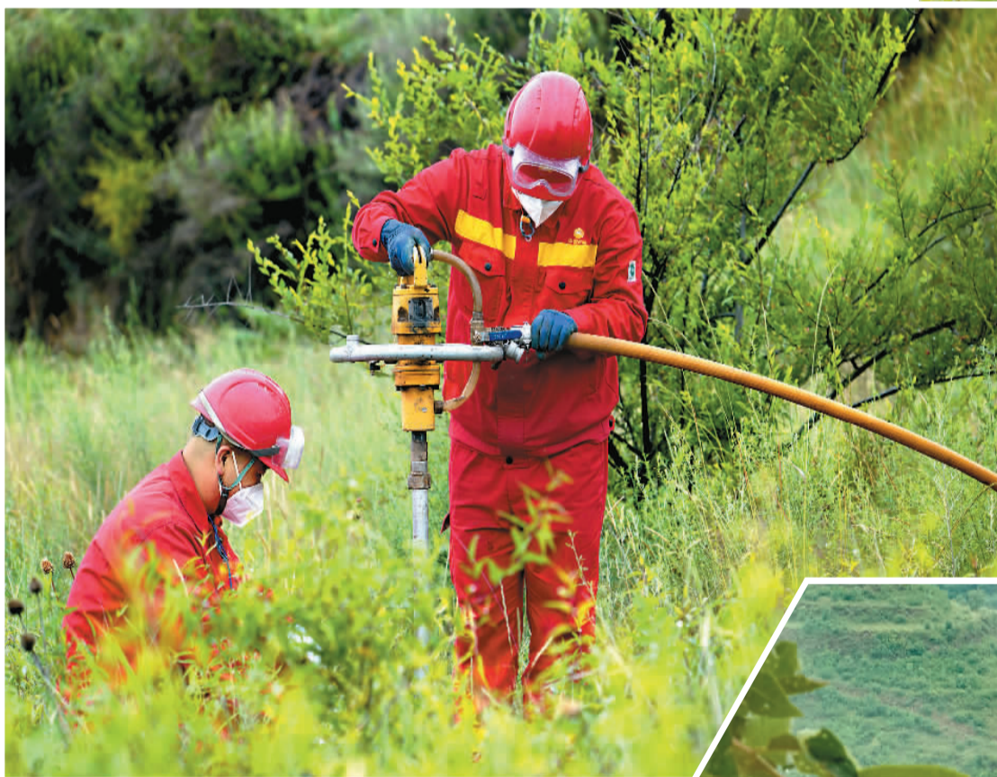
▲ 勘探队员在埋置自主研发的eSeis节点仪器。
