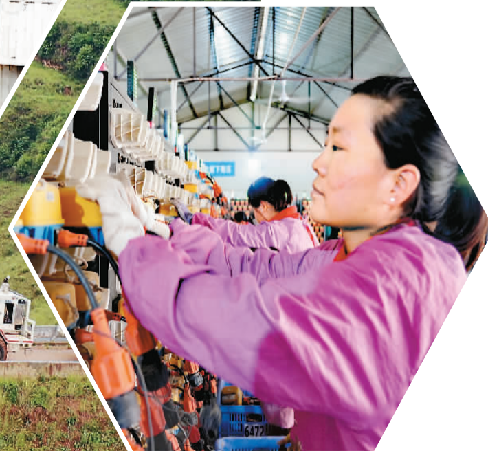
▲ 工作人员在数据下载中心下载eSeis节点仪器采集数据并充电。
