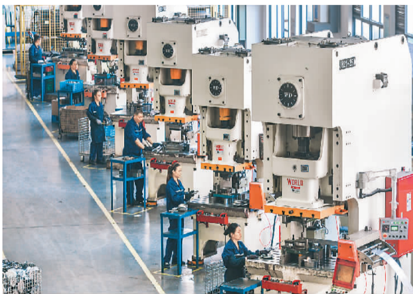
位于浙江省湖州市德清县雷甸镇的浙江南元泵业有限公司在巩固国内市场的同时，积极拓展海外市场，外贸出口占比持续攀升，销售额实现快速增长。图为工人在该公司生产车间生产立式多级离心泵零部件。
