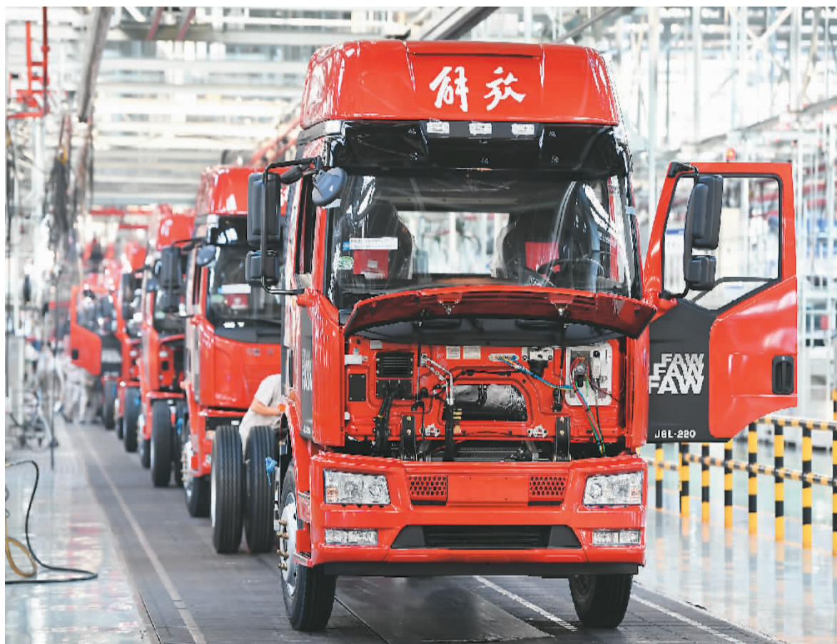
位于吉林长春的一汽解放总装车间,中国自主研发的新型卡车在生产线上等待装配。新华社记者 张楠摄
