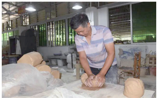
▲在拉坯前，師傅要用雙手搓揉泥塊，把泥團中的空氣擠壓出來。
