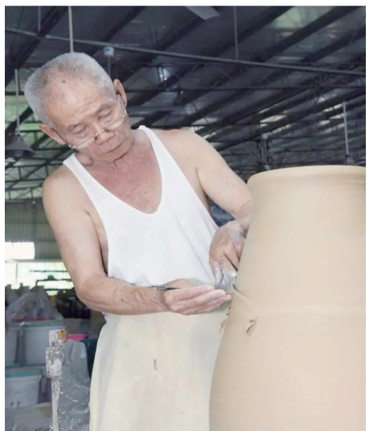
▲羅放榮是非遺項目陶瓷燒制技藝大埔縣級傳承人，他正在修坯。
