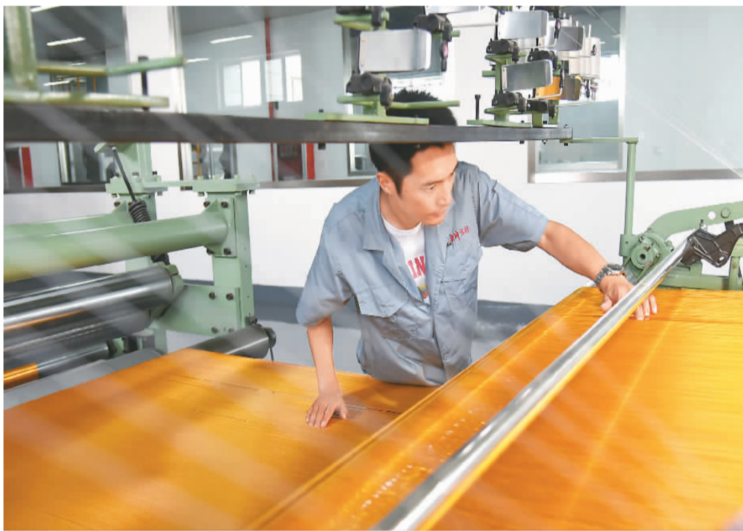
近年来，江苏连云港经济技术开发区积极推进国家碳纤维复合材料试验公共服务平台的建设和运营，推动碳纤维复合材料在轨道交通、汽车等领域的应用及推广。图为6月3日，公共服务平台的技术人员正在查看刚性剑杆织机运行情况。 耿玉和摄（人民视觉）
