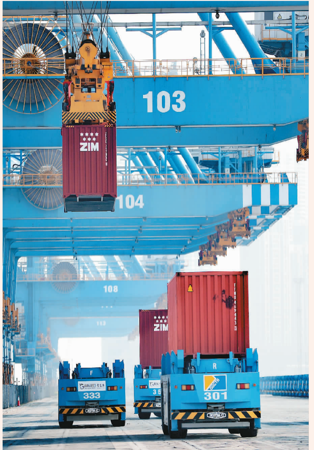
图为位于山东自贸试验区青岛片区的山东港口青岛港全自动化码头，自动导引车快速进行进装运货物。
