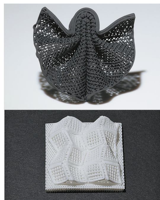
呂堅帶領團隊首創的陶瓷4D打印，可衍生一系列形狀相似又連續可變的結構，大幅增加催化劑效率和壽命。等，又與廣州醫療檢測機構進行一項新冠病毒快速測試合作研究。
