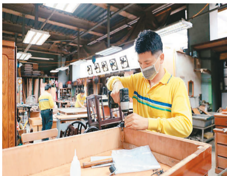
台北市环保局木工厂内，师傅正在耐心修复废旧旧木柜组件。许宸瑾摄
