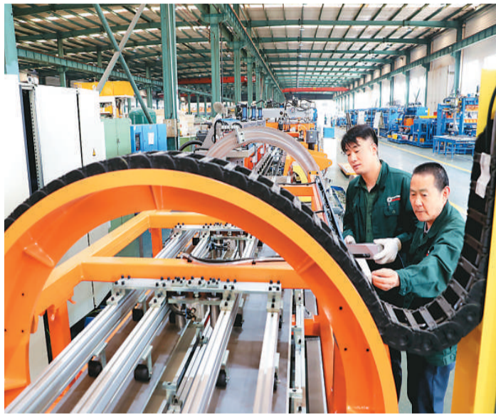
图为4月19日，安徽省滁州市经济技术开发区内，鲲鹏装备模具制造有限公司总装车间技术人员在调试出口海外的全自动冷柜外壳生产线设备。 李晓明摄（人民视觉）
