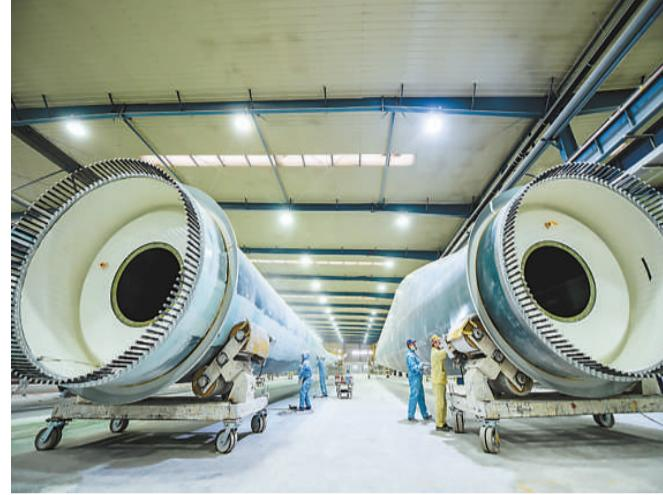
近期，位于内蒙古鄂尔多斯市东胜区的鄂尔多斯装备制造工业园区各部门为企业提供精准服务，助力企业提质升级。图为园区内一家新材料科技股份有限公司的工人在进行风叶壳外部补强作业。
