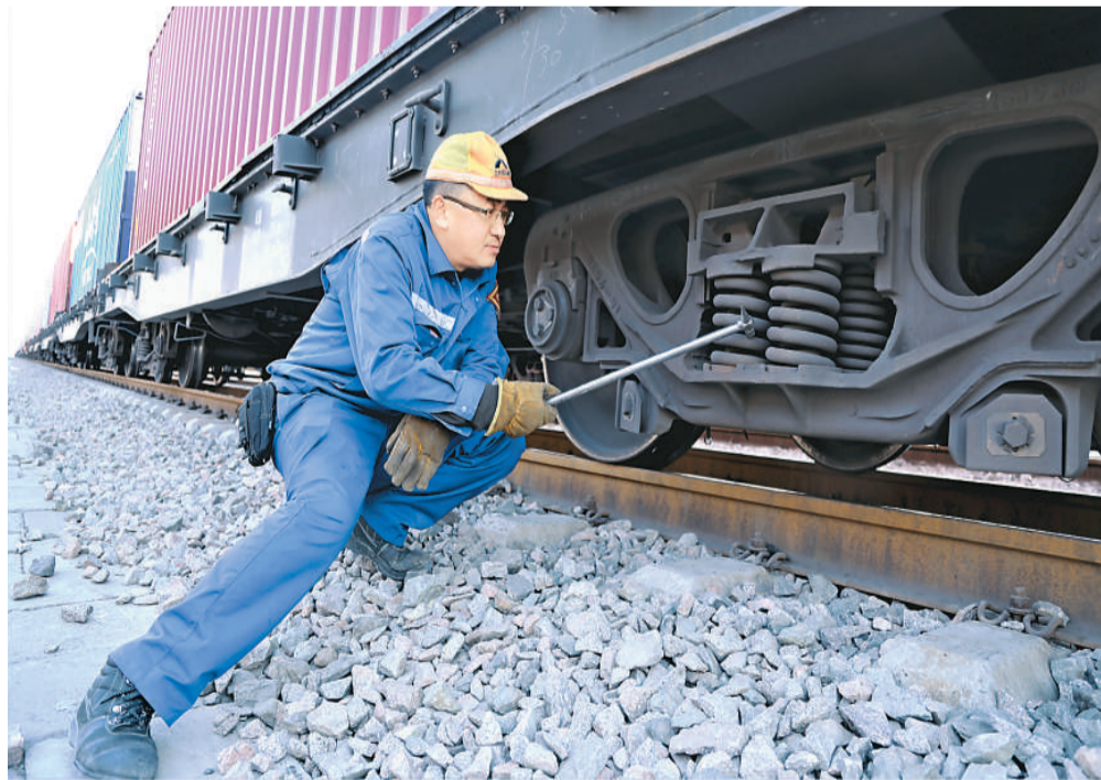
图为兰州西车辆段货车检车员正在检查中欧班列的车辆走行部技术状态。兰州西车辆段供图
