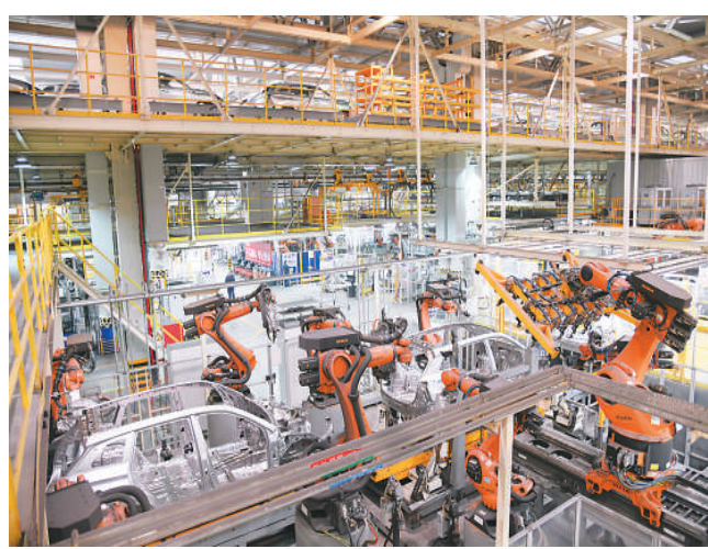
安徽省合肥高新区合肥长安汽车有限公司近年来不断提高高科技水平，打造自动化、智能化生产车间，推动绿色、高质量发展。图为3月18日，该公司焊装车间内机器人在生产流水线上作业。方 好摄（人民视觉）
