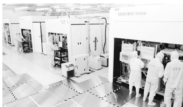
中国电科旗下电科装备科技人员对研制成功的离子注入机进行相关测试。中国电科供图
