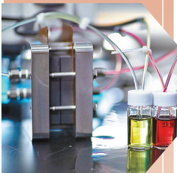
「簡版」的水系液流電池系統。受訪者供圖
