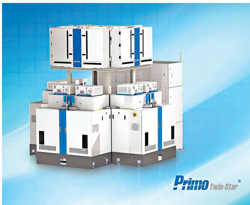
●中微公司雙反應台電感耦合等離子體刻蝕設備Primo Twin-StarR。受訪者供圖
