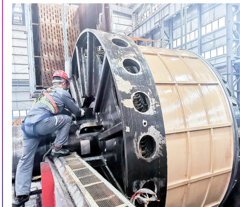
十二兆瓦海上半直驱永磁同步风力发电机定子正在进行绝缘工艺处理。
