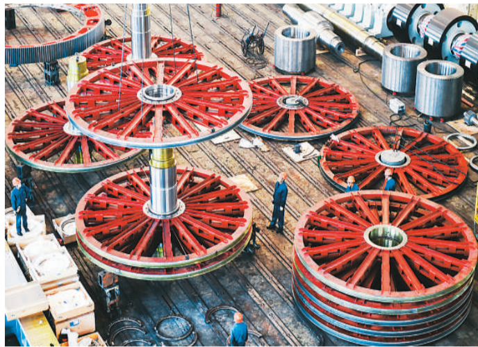
不久前，位于河南洛阳的中信重工装配车间内，工人正组装一批直径5米的多绳摩擦式矿井提升机天轮装置。 黄政伟摄（人民视觉）
