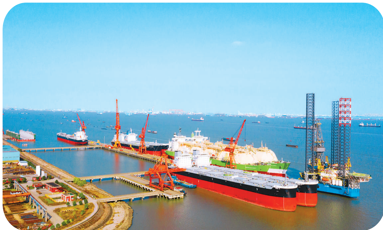
2020年12月9日，江苏省太仓港经济技术开发区一家造船企业码头，主体建造完工的船舶进入装配、调试阶段，即将交付国内外船东。 计海新摄（人民视觉）
