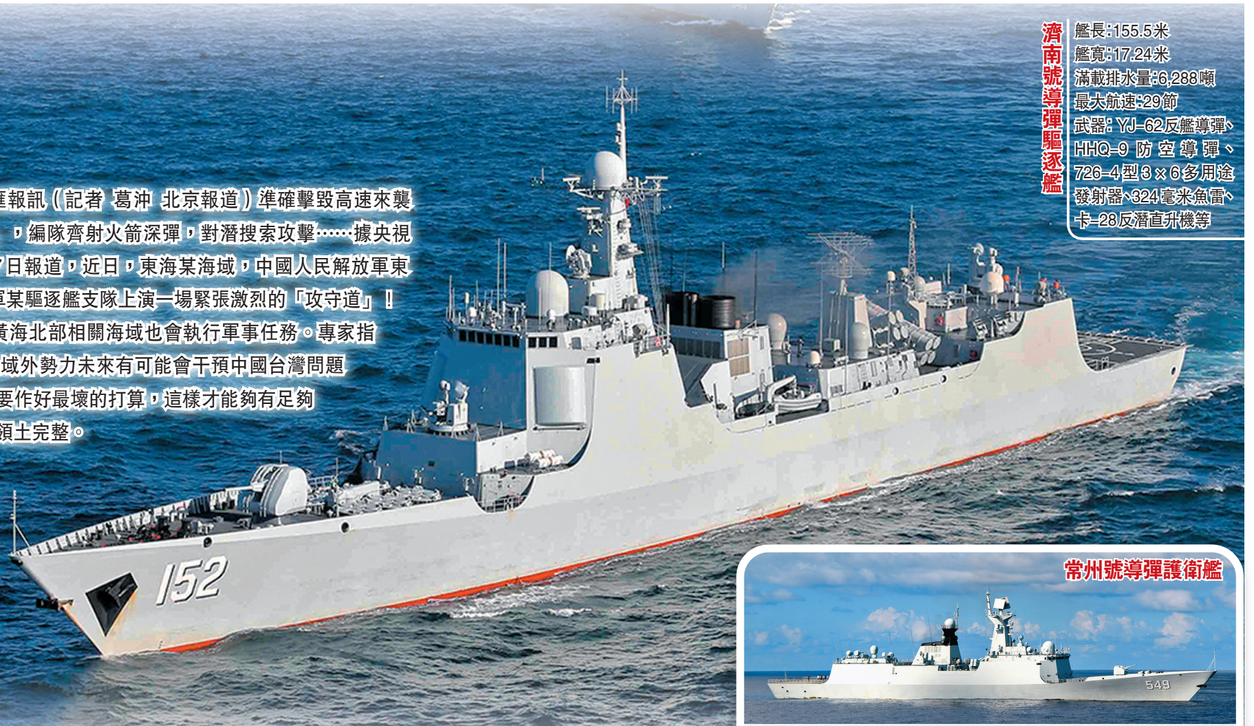
常州號導彈護衛艦 艦長:134米 艦寬:15.2米 滿載排水量:4,053噸 最大航速:27節 武器: YJ-83反艦導彈、紅旗-16防空導彈、魚-7型魚雷、反潛火箭、直-9C型反潛直升機等
