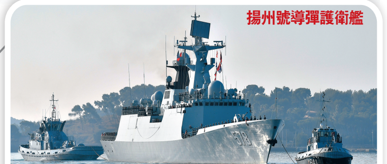
揚州號導彈護衛艦 艦長:135米 艦寬:16米 滿載排水量:4,000多噸 最大航速:27節 武器: YJ-83反艦導彈、紅旗-16防空導彈、魚-7型魚雷、反潛火箭、直-9C型反潛直升機等
