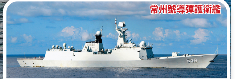
常州號導彈護衛艦 艦長:134米 艦寬:15.2米 滿載排水量:4,053噸 最大航速:27節 武器: YJ-83反艦導彈、紅旗-16防空導彈、魚-7型魚雷、反潛火箭、直-9C型反潛直升機等
