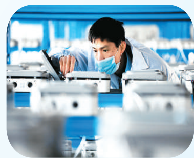
1月12日，在江西省赣州市章贡区驴充无充电技术有限公司，工人在检测即将出厂的电动自行车充电桩。 王 淮摄（人民视觉）
