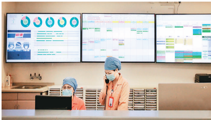
手术室智能仪表盘可显示医护人员的实时位置、医疗仪器的分布、手术室正进行的手术及其进度等。李泽彰摄
