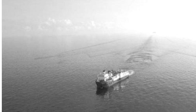
图为搭载“海亮”和“海途”的物探船进行三维地震采集作业。 中海油服 供图 摄
