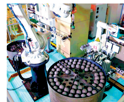
國產高溫氣冷堆核燃料元件生產線。網絡圖片
